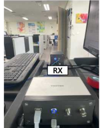
그림 2 (좌) 콘크리트 벽 반사파 각도 추정 환경, (중) 송신단 28 GHz 트랜시버, (우) 수신단 28 GHz 트랜시버
