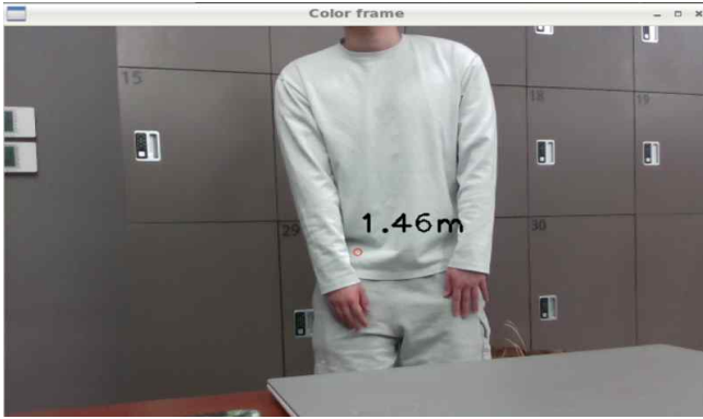
그림 1. D435i 카메라를 이용한 객체와의 거리 측정
