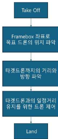
그림 3. 드론 제어 시스템 플로우
