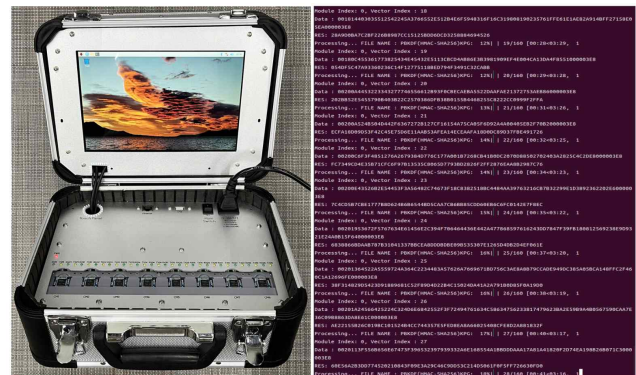
[그림 4] DUSSQ CAVP 시험 도구의 동작 및 결과 화면
