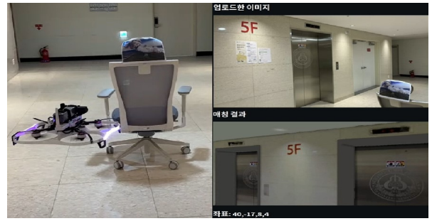
그림 4. 자율 정찰 시스템 결과 (좌: 드론이 자율 비행하여 도착한 목적지, 우: 상단은 실제 이미지, 하단은 가상공간 매칭 결과)
