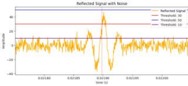
그림 3. 노이즈(SNR=2dB)가 있는 반사된 신호와 각각의 임계값 설정
