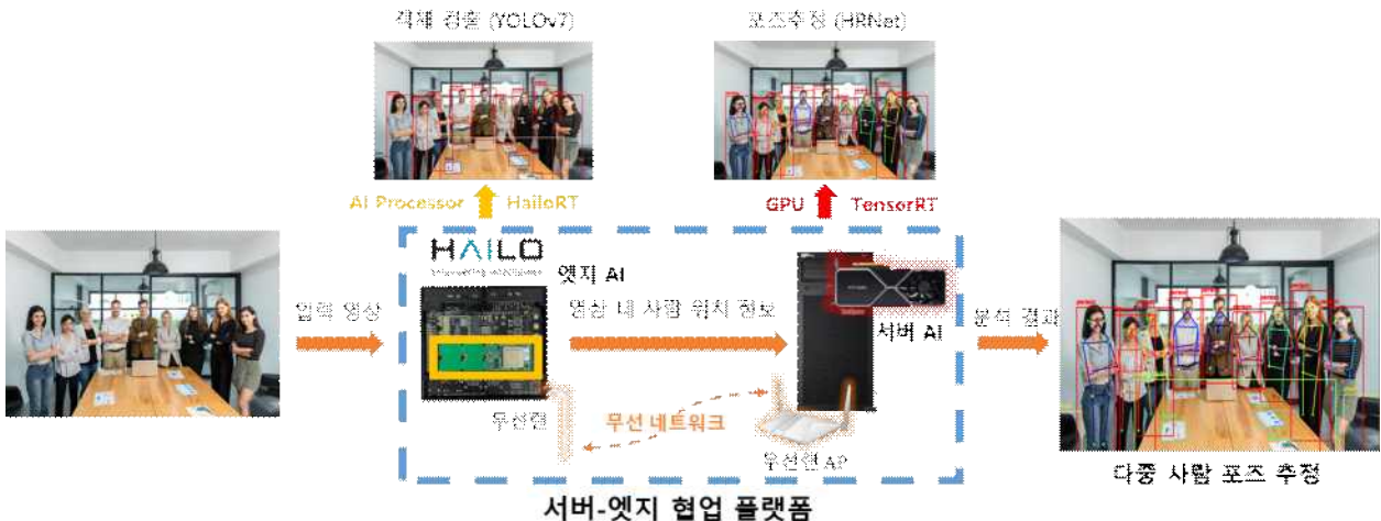
그림 1. 서버-엣지 협업 기반 다중 사람 포즈 추정 시스템 구성도
