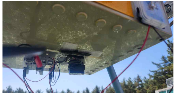
그림 4. 드론 하부에 장착된 모듈과 LED 디스플레이
