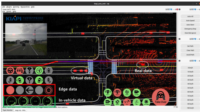
그림 4. Co-simulation 시스템 시각화 결과
