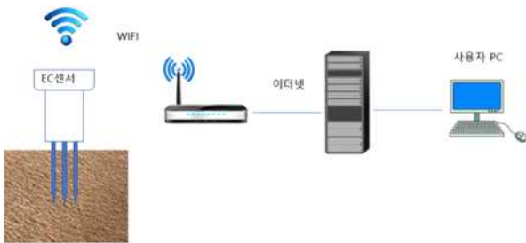
그림 1 무선 토양 센서 모니터링 동작 개요도 Figure 1. Wireless soil sensor monitoring operation schematic diagram
