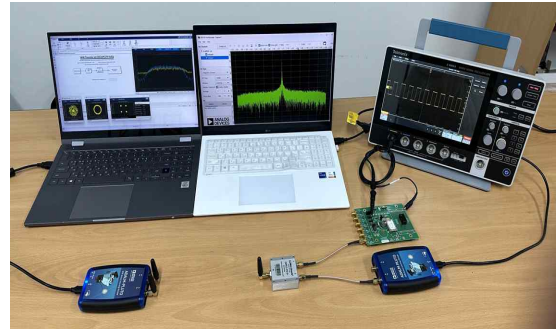
<그림3. 구현된 무선 전력/정보 동시 전송 시스템>
