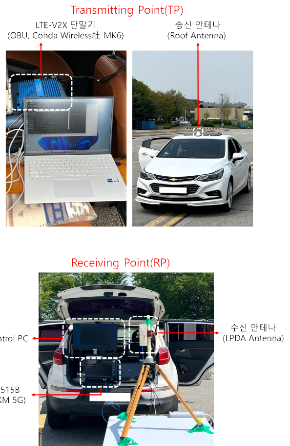
그림 1. 송·수신 측 시험 환경 구성
