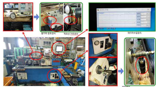
그림 2 전조 공정의 제조 데이터 수집을 위한 센서 설치
