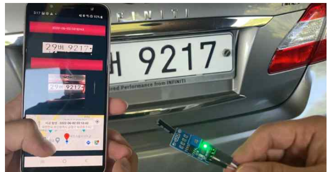
[그림 5] 차량 사고 감지 및 관리 시스템 실험
