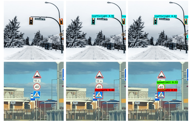
[그림 4] (a) 원본 도로 이미지 (b) 기존 YOLOv3 객체 탐지 결과 (c) 수정된 YOLOv3 객체 탐지 결과
