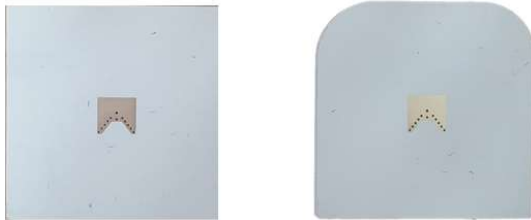
(a) 다각형 패치 (b) 다각형 패치/기관 모서리 원호 그림 3 제안한 안테나 제작 형상
