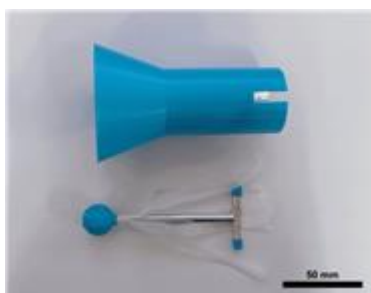
Figure 1. 3D 프린터로 제작된 자체 구동 풍속 센서의 부속품
