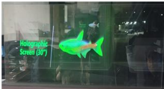
그림4. 레이저 프로젝터 영상을 재생한 30인치 HOE 스크린
