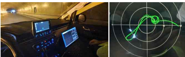
그림 8 GNSS신호발생기 시험시 생성신호가 DR항법모듈의 GNSS에 피드백되어 측위 오류 유발(1차시험 결과)
