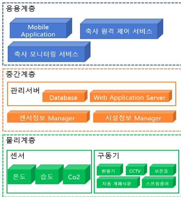
그림 1. 제안하는 스마트 축사 원격제어 플랫폼 구조 Fig. 1. Proposed smart barn remote control platform structure
