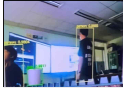
그림 5. YoloV3를 이용한 객체 탐지 및 객체 마킹 예시
