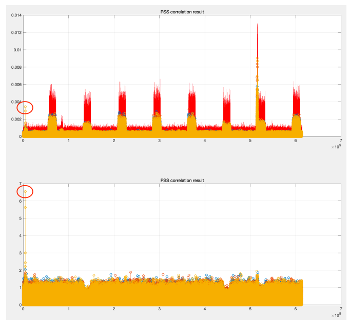
그림 4 실제 5G 신호에 대한 PSS detection 결과 (energy normalization 적용 전후)
