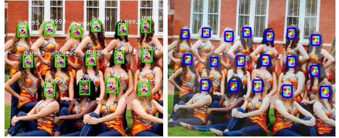
그림 2. 얼굴 및 랜드마크 검출 결과 이미지 (왼쪽: 최적화 전 GPU를 사용한 데스크탑에서의 결과 이미지, 오른쪽: 모델 최적화 후 모바일 상에서의 결과 이미지)
