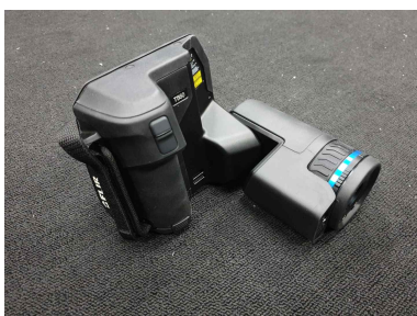
Fig. 1 열화상카메라 시료(FLIR사 T560제품)
