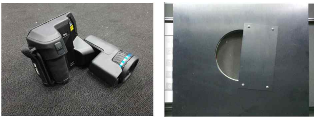
Fig. 4 Slanted-Edge target을 이용한 해상력 측정 전
