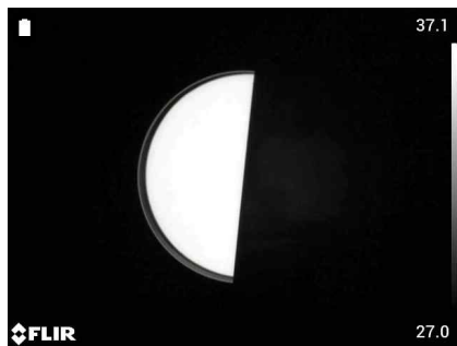
Fig. 5 Slanted-Edge target을 이용한 해상력 측정 이미지
