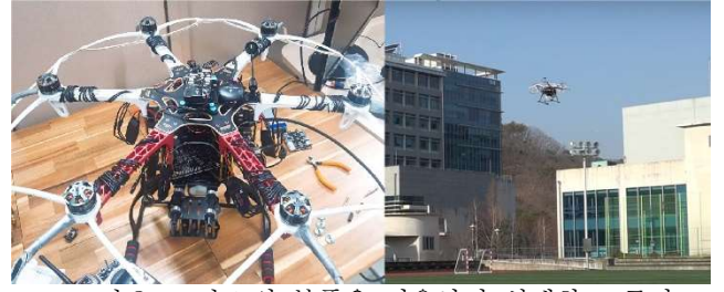
그림 2. 그림 1.의 부품을 이용하여 설계한 드론과 드론의 비행 시연 모습.
