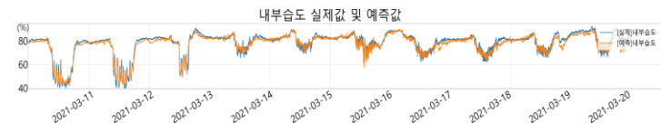
그림 2. 2021 년 3 월에 수집된 ‘내부습도(1 번)’ 센서의 측정값과 예측값 비교. 파랑 선은 해당 내부습도 센서의 실제 측정값을 나타내며, 주황 선은 예측값을 나타낸다.
