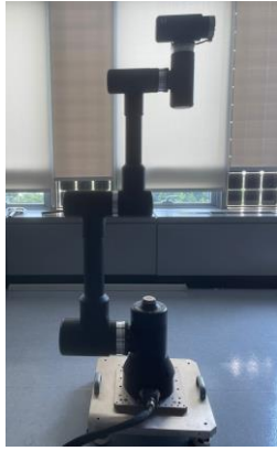
그림 1. 실험에 사용한 6축 다관절 로봇
