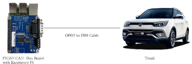
그림 1. 실제 차량에서 CAN 통신 데이터 수집을 위한 실험 구성도
