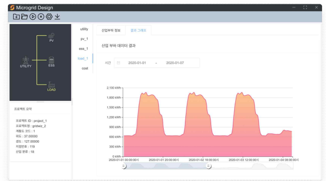
그림 2. 산업용 마이크로그리드 최적 용량 설계 시뮬레이터: 산업설비 부하 예측
