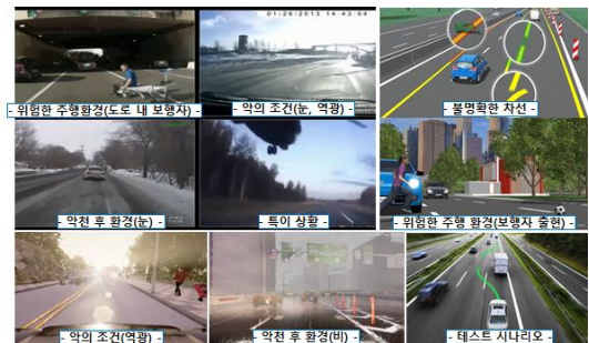
그림 1. 시뮬레이터를 이용한 코너 케이스 재현의 예
