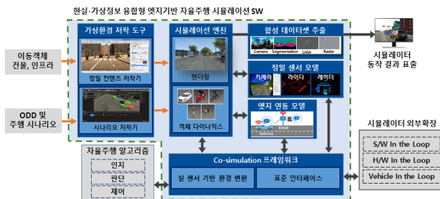
그림 3. 현실-가상정보 융합 시뮬레이터 구조
