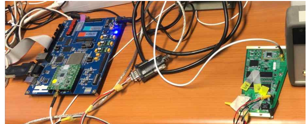
[그림 8] Guardian-E IP를 탑재한 FPGA 개발환경
