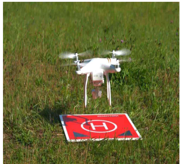
[그림 1] 착륙 패드를 이용한 이·착륙 자동화
