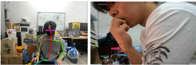
그림 2. 신체의 관절 포인트 추출 그림 3. 옴로를 이용한 객체 인식
