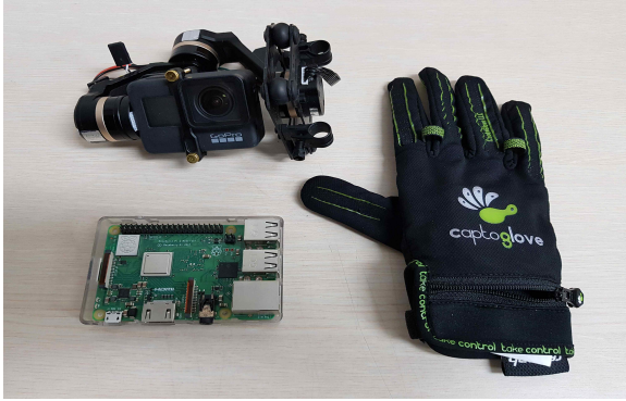
그림 2 주요 하드웨어(CaptoGlove, Tarot T-3D, Raspberry pi 3B+)
