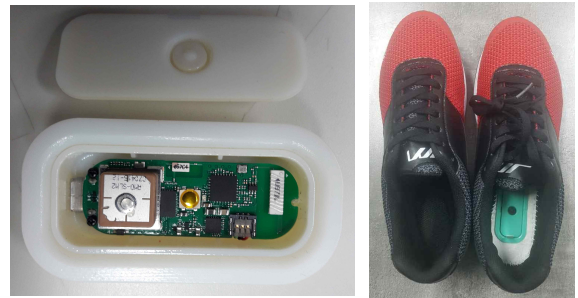
그림 3. 구현된 LoRa 기반 가입자 단말기와 신발에 삽입된 모습
