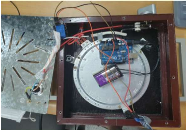
그림 1. 하이라이트와 릴레이와 일산화탄소측정센서 연결된 내부 모습.
