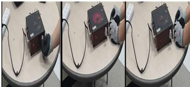
그림 3. 하이라이트기가 가스 주입 후 전원이 차단되는 모습.
