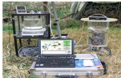
그림 2. 질량측정 방식의 강수량계 교정시스템(현장용)
