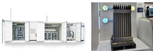
Figure 6. (a) Elchemtech사의 PEM 수전해 설비 및 (b) 한화솔루션의 AEM 수전해 스택의 이미지.
