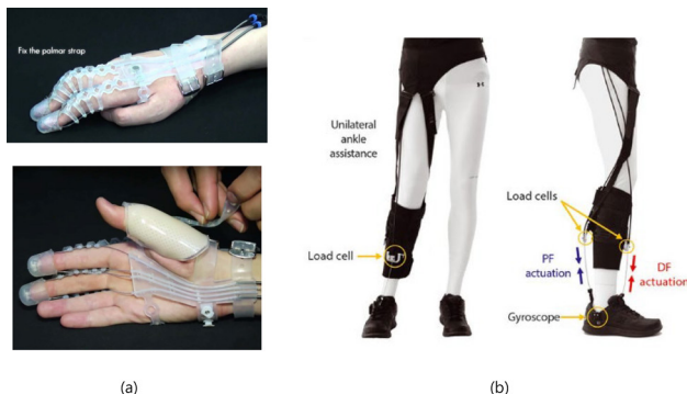
Figure 4. 소프트 웨어러블 로봇의 구조와 착용 사례: (a) Exo-Glove Poly II 손용 외골격 장갑[8], (b) 섬유 기반 모듈형 하지 보조 Exosuit[63]
