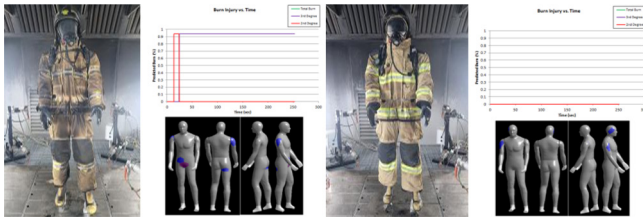
Figure 13. 화염마네킨 8초 화염 노출 후 소방복 외관 및 화상 예측. (좌) DRY 상태, (우) 겉감 WET100% 상태, 국립소방연구원 화염마네킨 실증평가 진행
