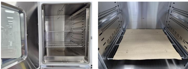
Figure 8. (좌) 내열성 시험 장치. (우) 장치 안 거치된 시험편 모습.
