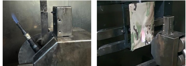
Figure 9. (좌) 난연성 평가 버너 장치. (우) 장치에 거치된 시험편 모습.
