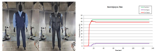
Figure 5. (좌) GS칼텍스 작업복(아라미드/모다크릴 혼방) 화염 마네킨 3초 화염 노출 전/후 외관. (우) 시험결과.
