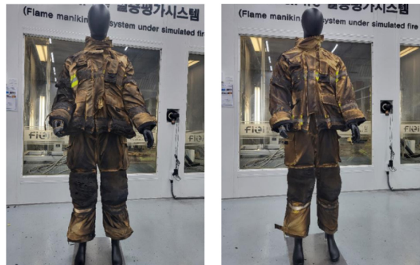
Figure 6. 화염마네킨 8초 화염 노출 후 외관 (좌) 결감 : 아라미드100%, (우) 결감 : PBI 40%+아라미드 60%.
