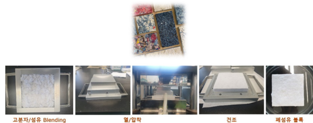
Figure 7. 섬유 업사이클링을 통한 신소재 블록 및 섬유 업사이클링 공정.
