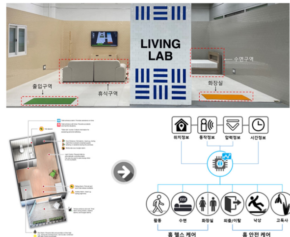
Figure 5. 압력섬유 센서를 이용한 스마트홈 시 기술.
