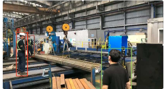
그림 5. IOU 매칭과 Re-ID 매칭 기반 객체 추적 결과 Fig. 5. Object Tracking Results Using IoU and Re-Identification Matching.
