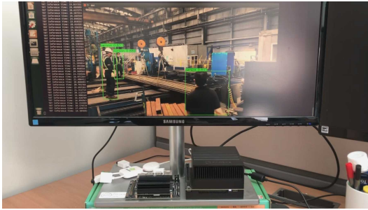
그림 1. 엣지 컴퓨팅 환경에서 산업 현장 모니터링 시스템 Fig. 1. Industrial Site Monitoring System Based on Edge Computing.
