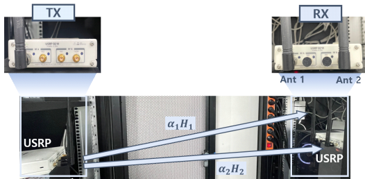
그림 5. USRP에 안테나를 연결한 SFLC-OFDM 테스트베드 Fig. 5. SFLC-OFDM testbed connected antenna to USRP
